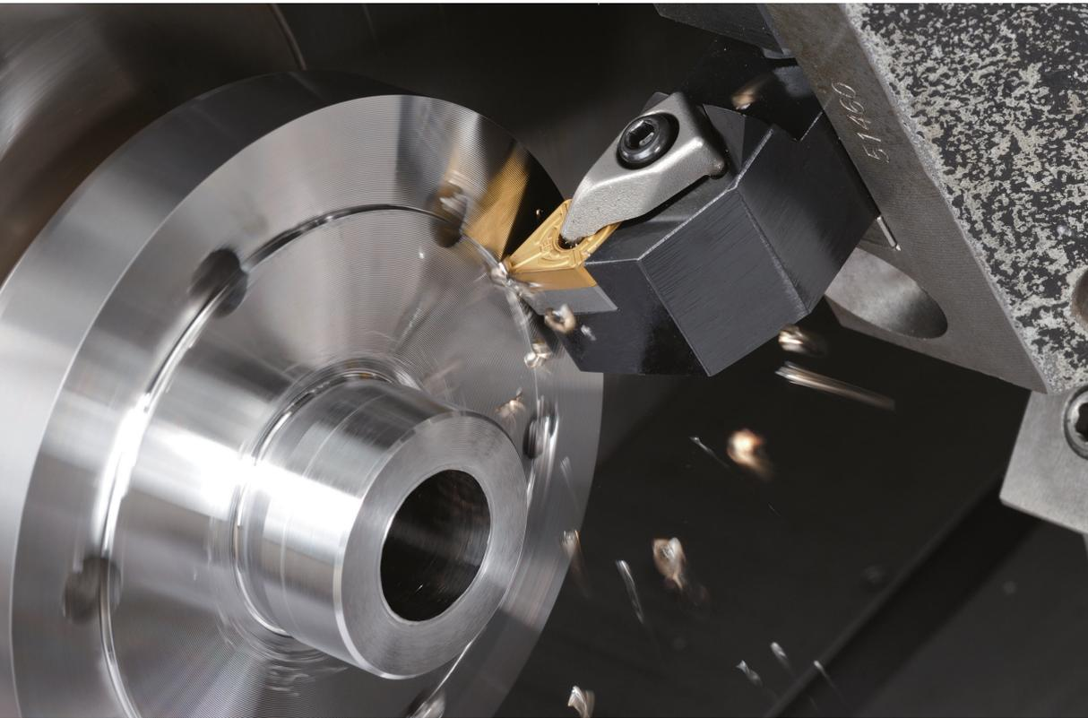
1 Speziell aufeinander und auf variierende Stahlsorten abgestimmte Beschichtungen der 'AC8000P'-Serie von Sumitomo ermöglichen Standzeiten in bislang unüblicher Größenordnung
